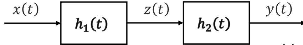
$$y(t) = z(t) * h_2(t) = x(t) * h_1(t) * h_2(t)$$
